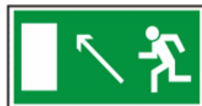
Направление к эвакуационному выходу налево вверх
