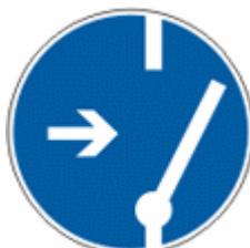
Отключить перед работой
