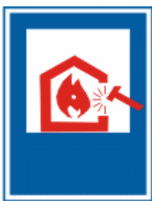
Место вскрытия конструкций
