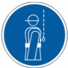
Работать в предохранительном поясе
