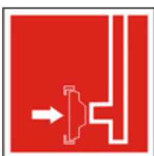
Пожарный сухотрубный стояк
